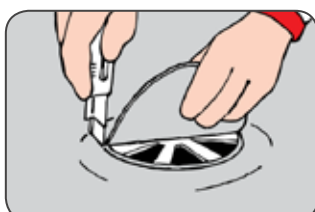
Skär rätt hålstorlek enligt golvbrunnens skärmall/kniv.
